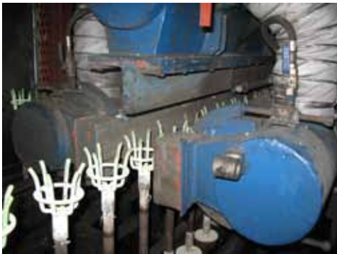
Şekil 13. Şoklama manifoldlarının eski (soldaki resim) ve nozüllü yeni tip (sağdaki resim) üfleme kafaları.
