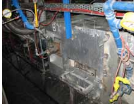
Şekil 9. Yakma Zonları çıkışına 1 adet yeni zon eklenmesi
